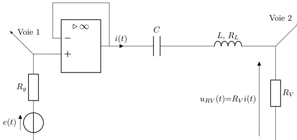
On prend  $L = 0,10 \text{ H}$ ,  $C = 0,10 \mu\text{F}$ ,  $R_v = 1,0 \cdot 10^2 \Omega$  et  $e_m = 2,0 \text{ V}$
