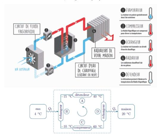
Le schéma synoptique représenté ci-dessus montre que la pompe à chaleur est constitué d'un fluide en écoulement (par ex. du fréon) subissant tout un cycle de transformations :
